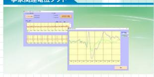
フリークエント・レア刺激提示、波形記録、加算平均、結果表示を行う ソフトが付きます。刺激は画像と音が選択できます。トリガー入力は刺 激提示用 P C に照度センサーを貼付けて片隅に表示される白黒マーカー を読取る方式です。同時に心電の計測が可能です。
