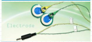
心電用電極ケーブルにディスポーザブル電極を取り付け、胸と右足に 貼ってください。ケーブル側のプラグを本体側のジャックに差し込み ます。
