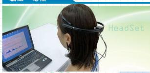
ヘッドセットに電極を差し込み被ります。
