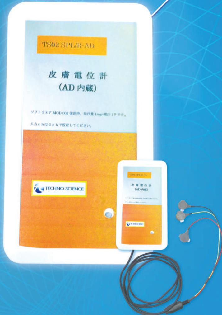
皮膚電気反応計、および皮膚電位計はエクリン汗腺の電気活動を測定し、心理的な動揺を数値化、またグラフ化するものです。GSR(皮膚電気反応)は精神性発汗の指標として用いられます。SPL/Rは、SPL(皮膚電気活動の直流成分)、SPR(皮膚電気活動の交流成分)の2成分を出力し、SPLは覚醒水準の指標、SPRは聴覚・視覚・痛覚などの刺激に対する反応として観察することができます。
